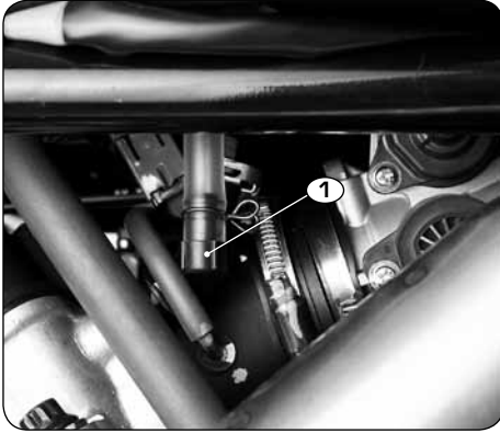
1. Dräneringsslangar från lufttrenaren
