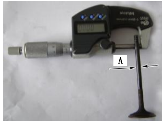
A. Valve Stem Diameter
