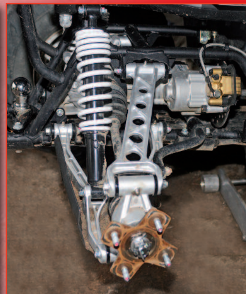
Hinterachse: Radführung mit Aluminium-Lenkern, Wellenbremse am Getriebeeingang
