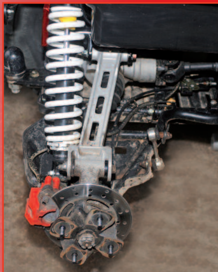
Radaufhängung hinten: Stahl-Dreieckslenker unten, Alustütze oben
