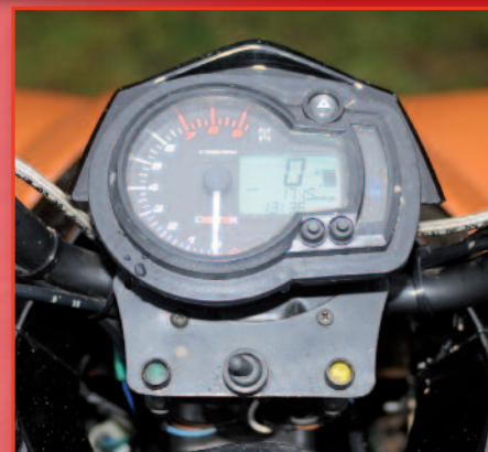
Übersichtlich: großer analoger Drehzahlmesser mit integriertem Digi-Tacho
