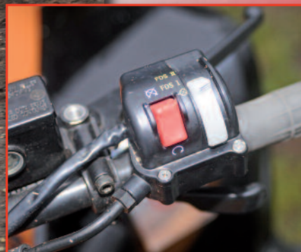
Elektrisch aktiviert: vordere und hintere Diffsperr
