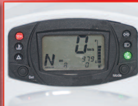
Kompakt: digitales Multifunktions-Instrument mit integrierten Kontrollleuchten
