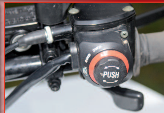
Fummelig: Drehschalter für Allrad- und Differenzsperren-Aktivierung
