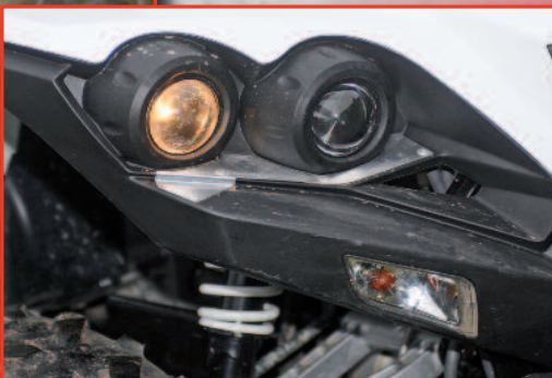
Hell: Gute Lichtausbeute dank Ellipsoid-Technik
