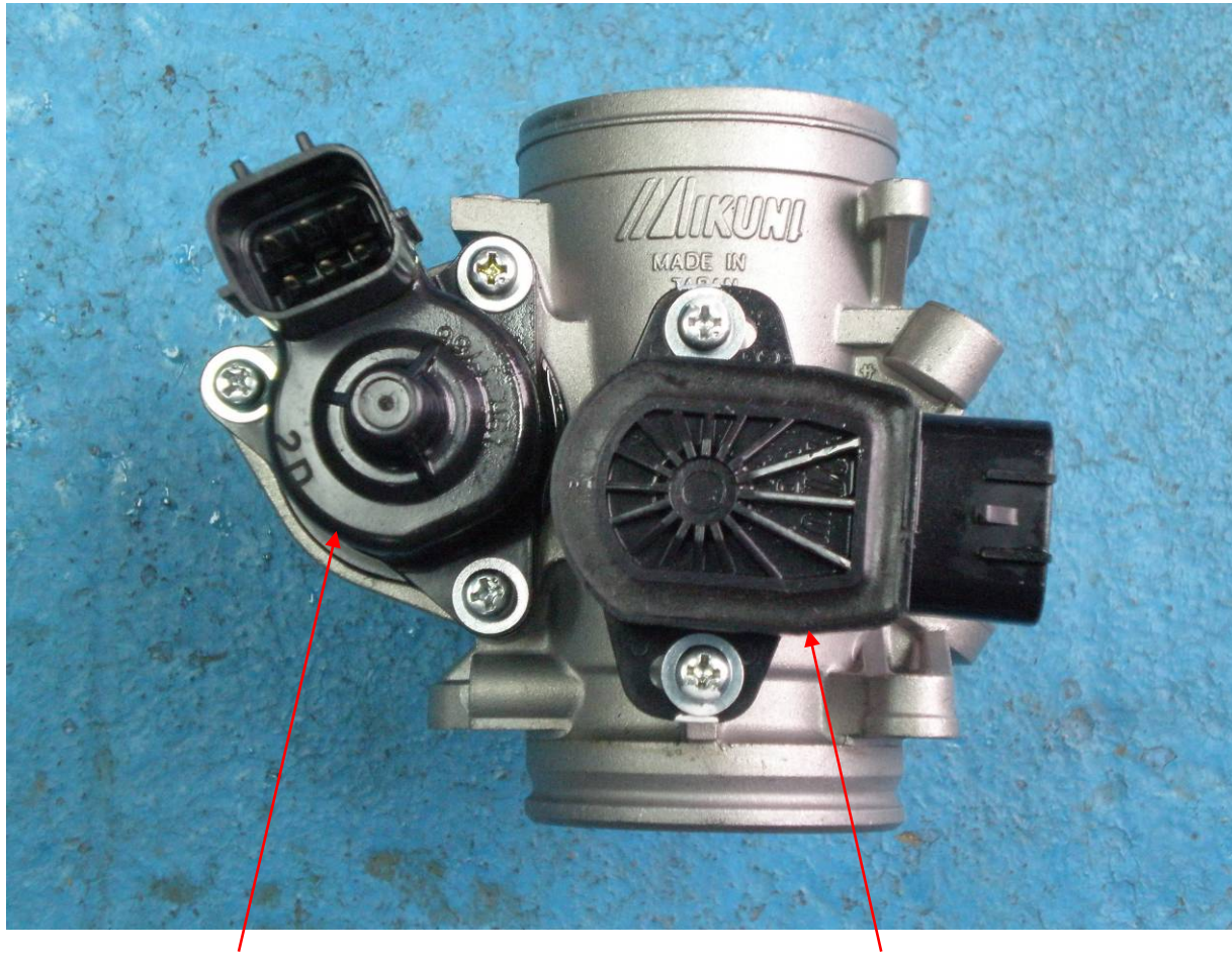
Regleringsventil Tomgång Inaktiv Luft Control Ventil (IACV)(Stegmotor)
